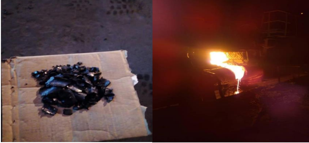
الشكل 2. عينة خبث افران الحديد والصلب.
