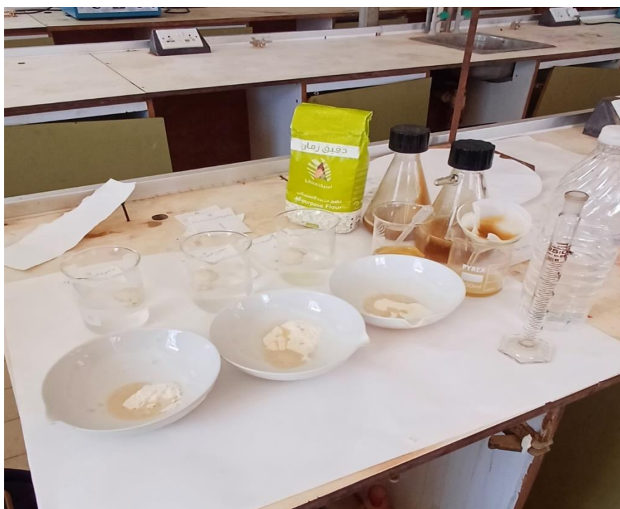
شكل (1) صورة توضح اختبار بلشنيك لعينات الدقيق منقوع التمر.
